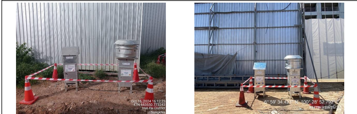
รูปที่ 39 ติดตั้งเครื่องตรวจวัดคุณภาพอากาศโดยทั่วไป
